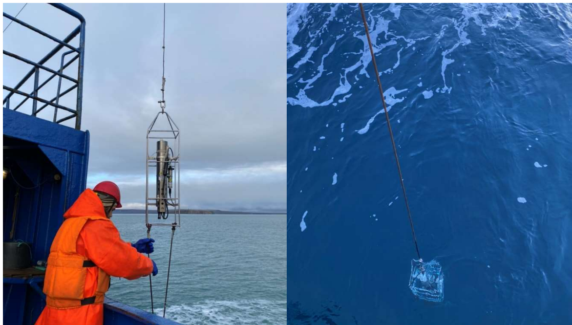
Рис 2. - СТД-зонд SEACAT SBE 19plus V2 (фото М.В. Григорьевой).
