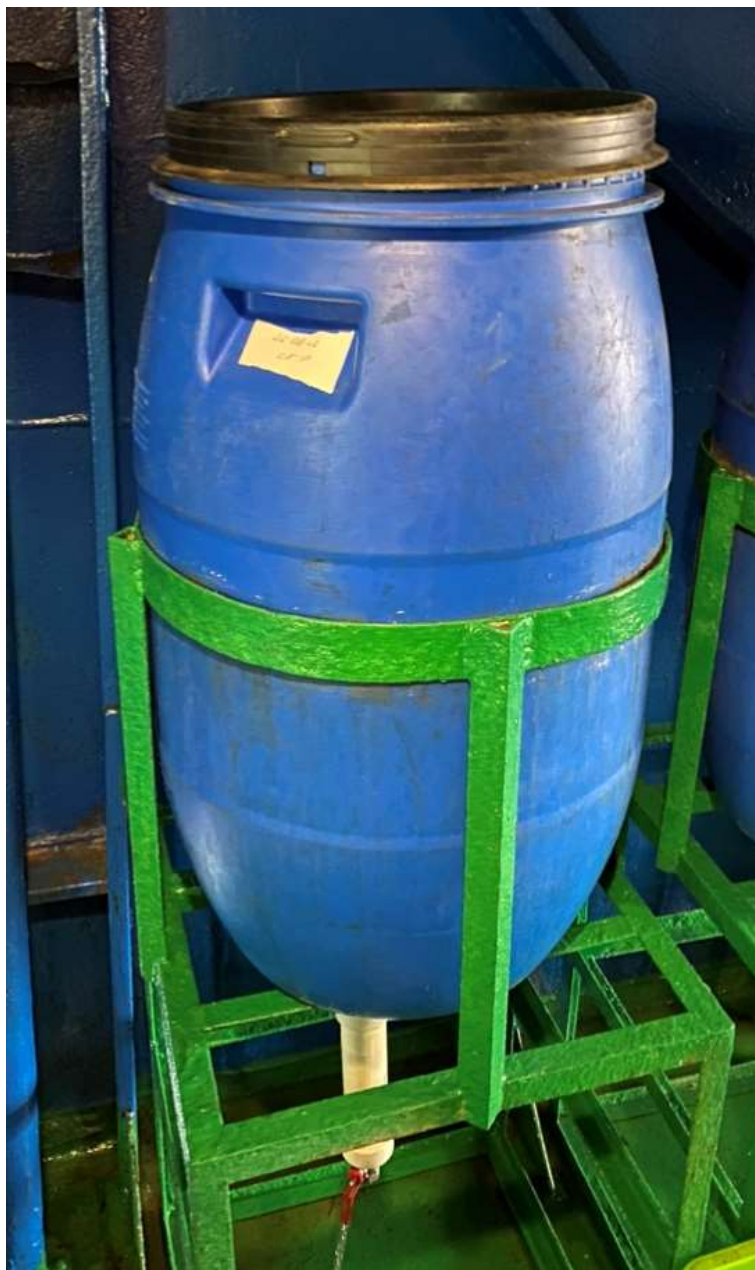
Рис 3. – Сорбирование морской воды для последующего определения удельной активности радионуклидов ^{137}\text{Cs} . (фото М.В. Григорьевой).
