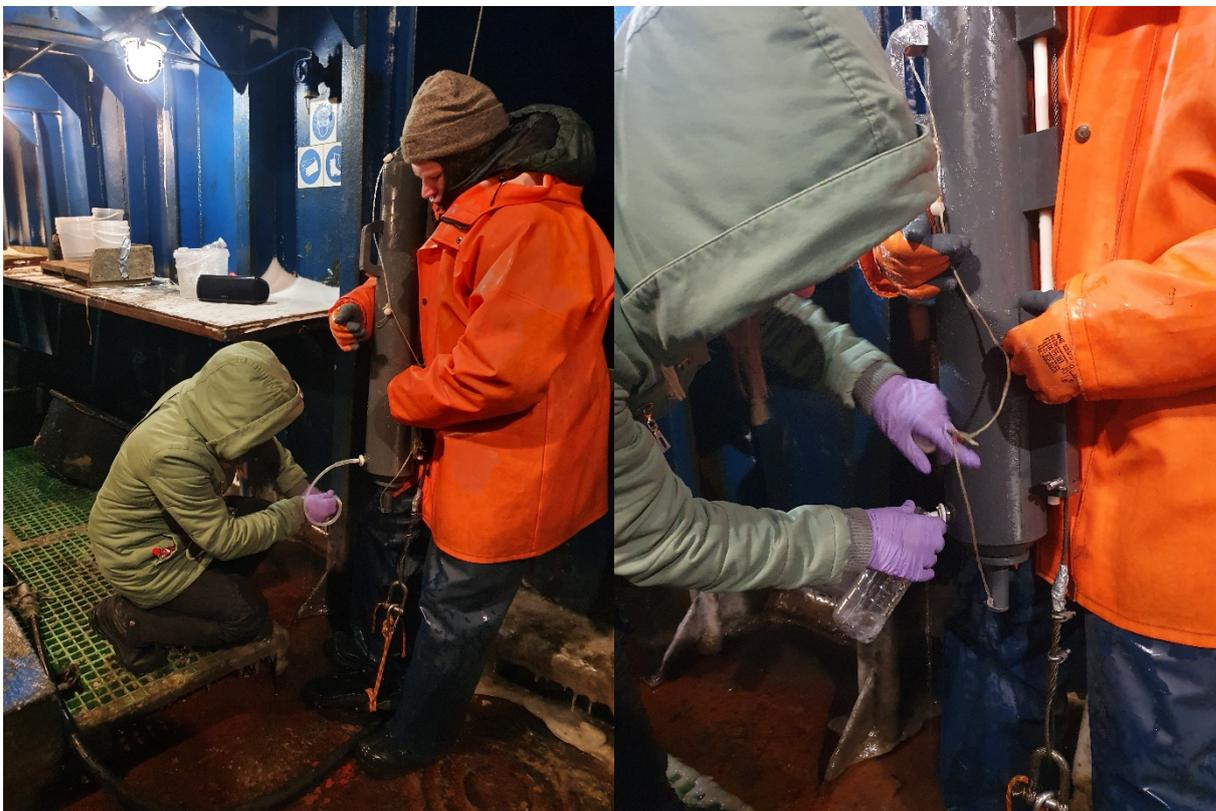
Рис. 4. Отбор проб воды из батометра для анализа гидрохимических показателей
