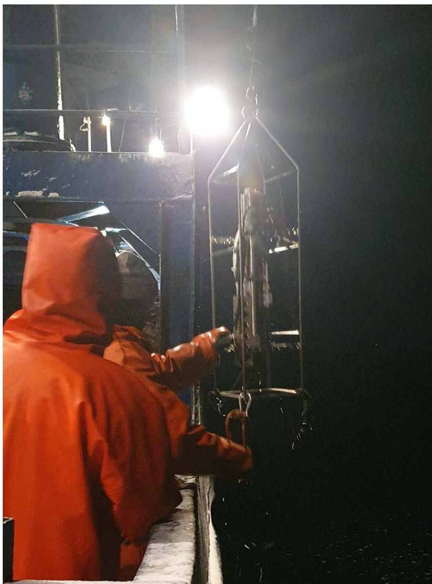
Рис. 3. СТД-зонд SEACAT SBE 19 Plus V2
