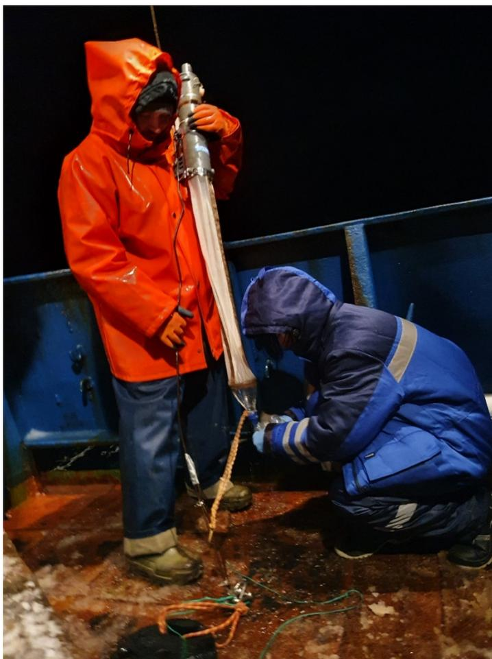
Рис. 6. Отбор пробы микрозоопланктона с помощью мелкоячейной сети, модифицированной батометром Нискина
