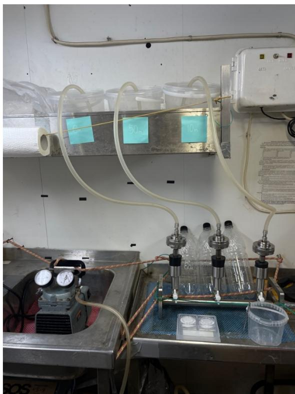
Рис. 5. Фильтровальная установка для первичной обработки морской воды на определение содержания хлорофилла *a*
