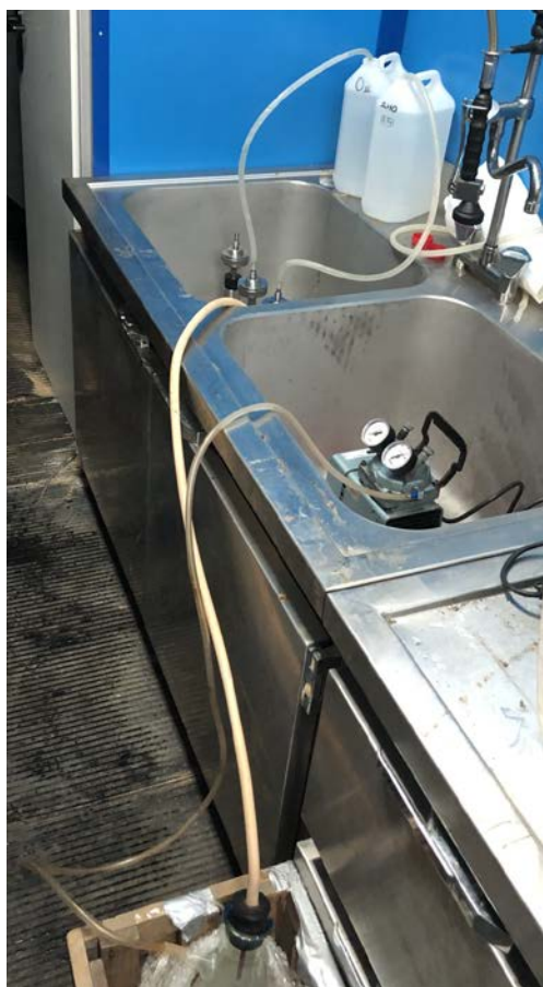
Рис. 3. Вакуумный насос и смонтированная установка для фильтрации морской воды на определение концентрации хлорофилла в условиях судовой контейнерной лаборатории (фото: Денис Моисеев)
