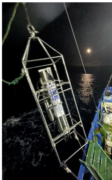
Рис. 2. СТД-зонд SEACAT SBE 19plus V2 (фото А.А. Дерябин)
