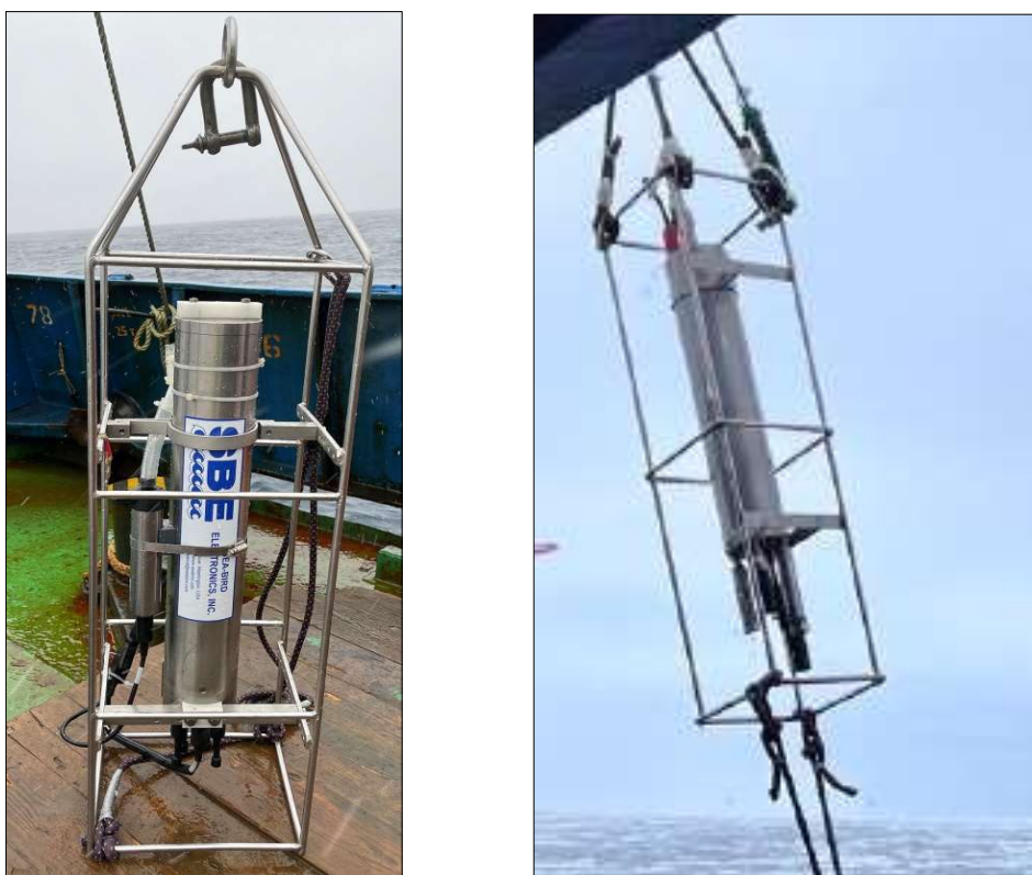
Рис. 2. СТД-зонд SEACAT SBE 19plus V2 (слева) и CTD 90 M Series II (справа) (фото Т.М. Максимовской)
