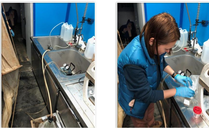
Фильтровальная установка для подготовки проб на хлорофилл *a*
