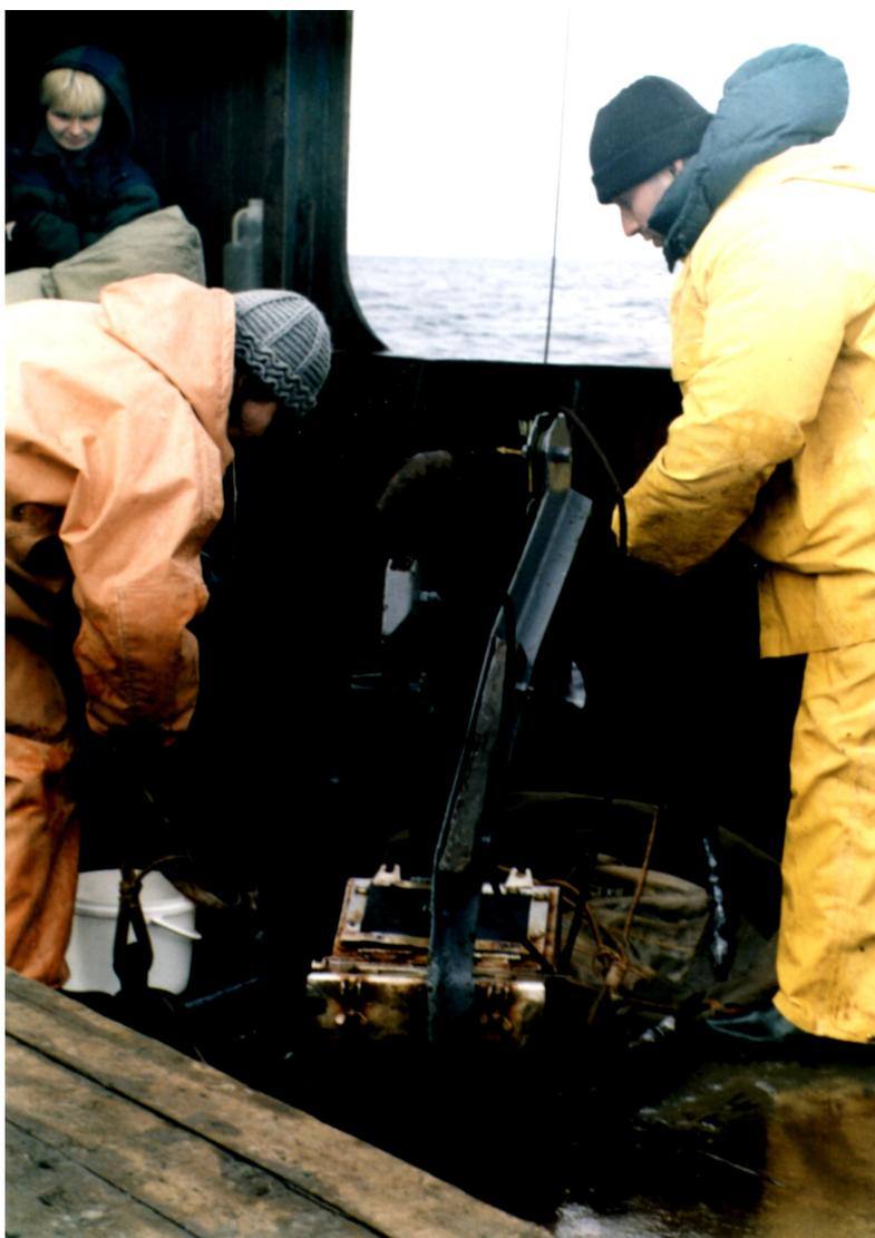
Рис. 19. Подъем бентосных дночерпательных проб.
