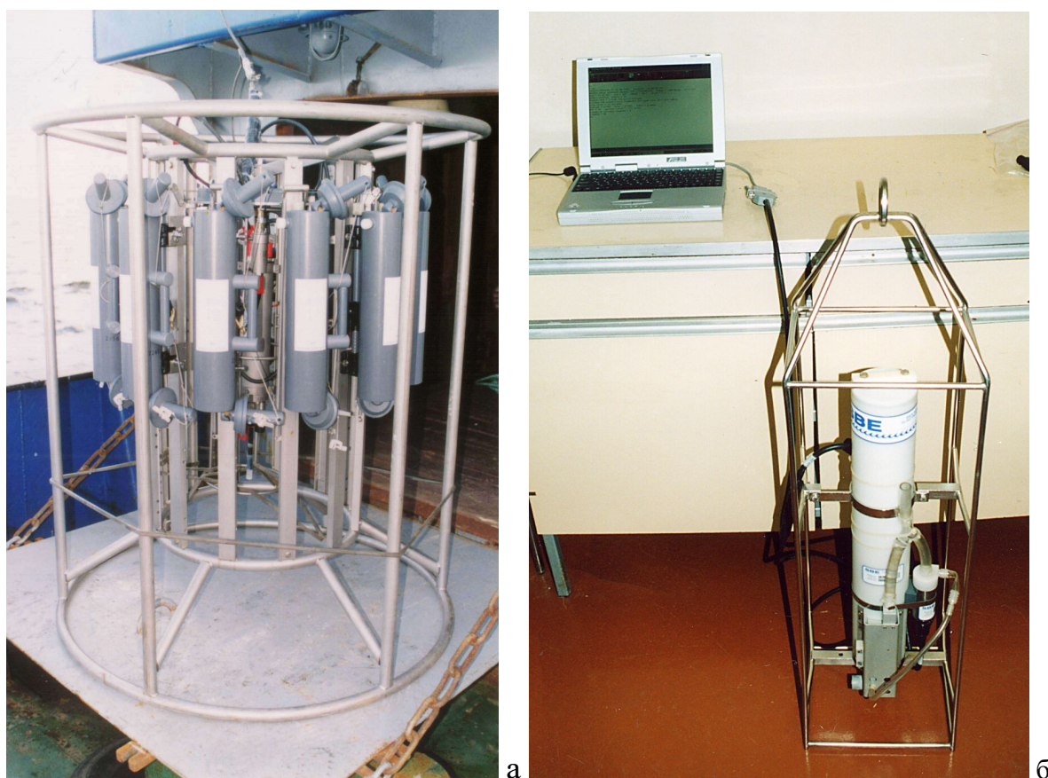
Рис. 2. Многоканальная телеметрическая система (а) и СТД-зонд SEACAT SBE 19 (б).
