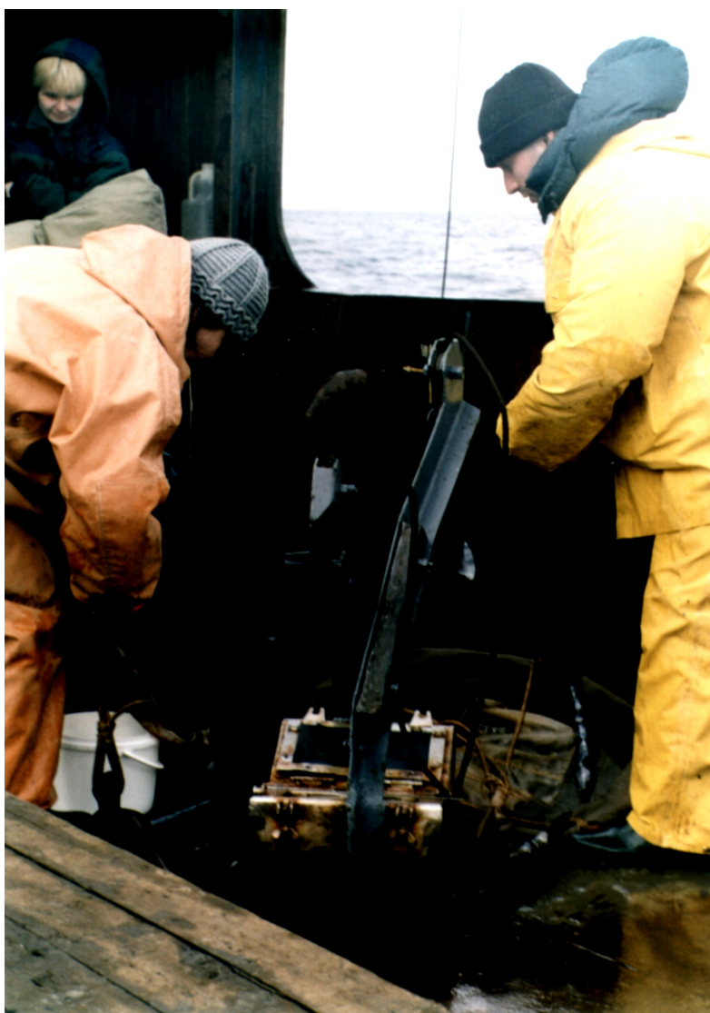
Рис. 19. Подъем бентосных дночерпательных проб.
