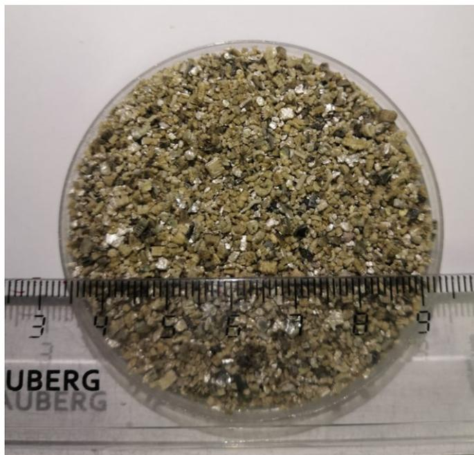
**Рис. 1.** Мелкофракционный термовермикулит
