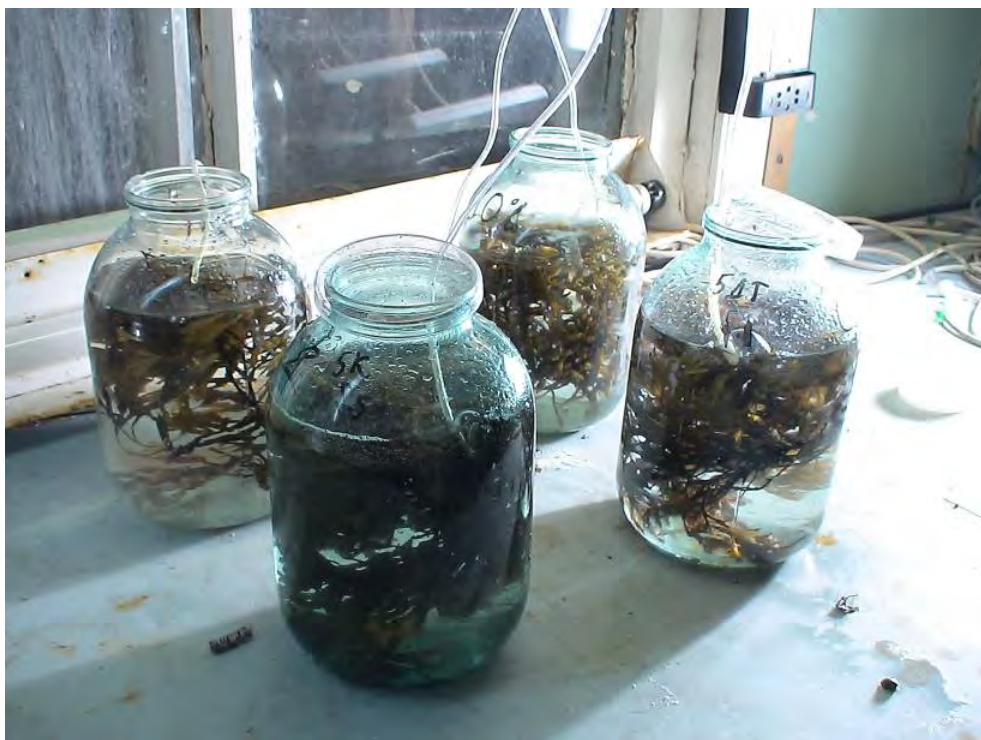
Рисунок 16. Экспериментальные емкости с морской водой, фукусовыми водорослями и дизельным топливом
