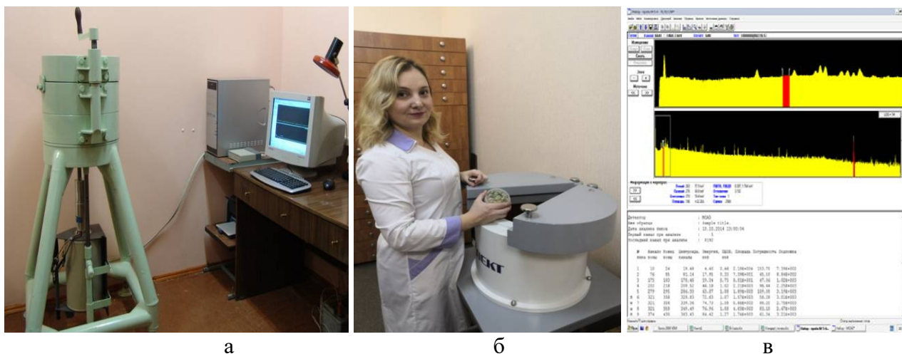
Рис. 2.13. Гамма-спектрометрический (а) и рентгеноспектрометрический (б) комплексы фирмы Canberra (а). Гамма-спектр образца донного осадка (в) / Fig. 2.13. Gamma spectrometry (a) and roentgen-spectrometry (б) equipment by Canberra (а). Gamma spectrum of bottom sediment sample (в)
