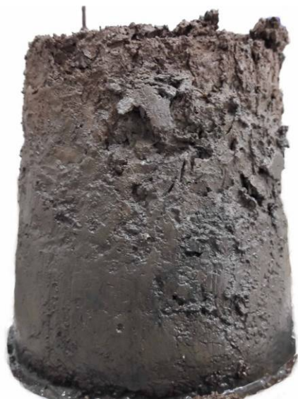
Рис. 4.1. Керн донных отложений, взятых в Кольском заливе. Включения гравия в слоях осадков. /
