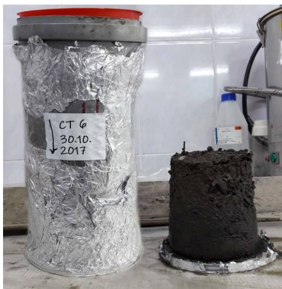
Рис. 2.11. Пластиковый пробоотборник и вырезанный керн донного осадка / Fig. 2.11. Plastic sampler and cut core of bottom deposit
