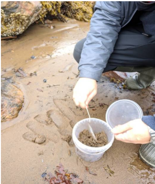
Рис. 2.10. Отбор проб поверхностного слоя донного осадка на литорали /
