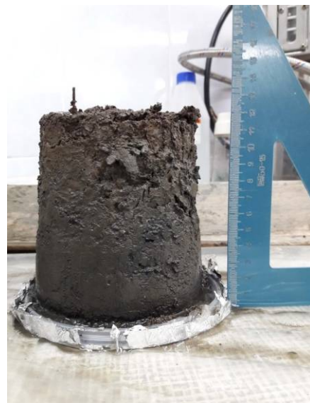
Рис. 2.11. Пластиковый пробоотборник и вырезанный керн донного осадка / Fig. 2.11. Plastic sampler and cut core of bottom deposit
