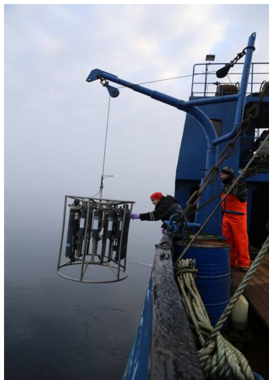
Рис. 2.4. Проведение гидрологических исследований и отбор проб воды на НИС "Дальние Зеленцы" / Fig. 2.4. Carrying out hydrological studies and water sampling at RV "Dalnie Zelentsy"
