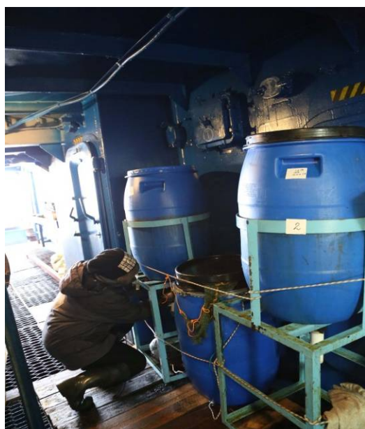
Рис. 2.5. Осаждение ^{137}\text{Cs} на сорбент "Анфеж". Отбор пробы седиментов / Fig. 2.5. Deposition of ^{137}\text{Cs} on "Anfezh" sorbent. Sediments sampling.
