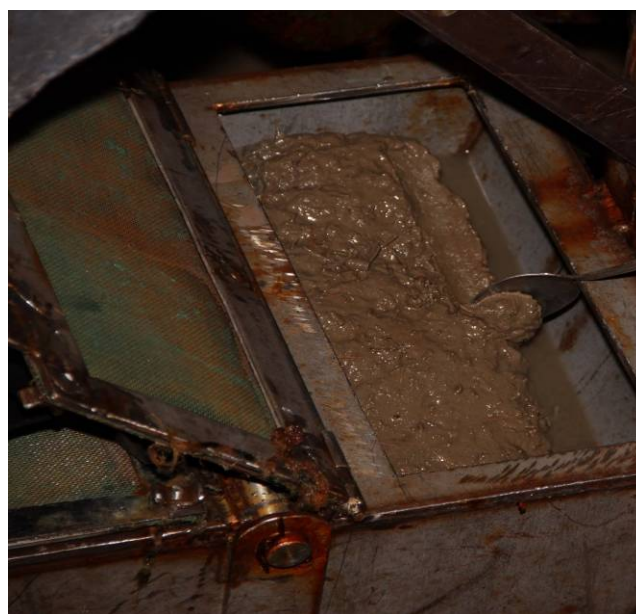
Рис. 2.5. Осаждение ^{137}\text{Cs} на сорбент "Анфеж". Отбор пробы седиментов / Fig. 2.5. Deposition of ^{137}\text{Cs} on "Anfezh" sorbent. Sediments sampling.
