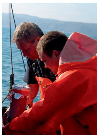
Упаковка пластиковой трубки с керном донного осадка Packing a plastic core tube with sediment
