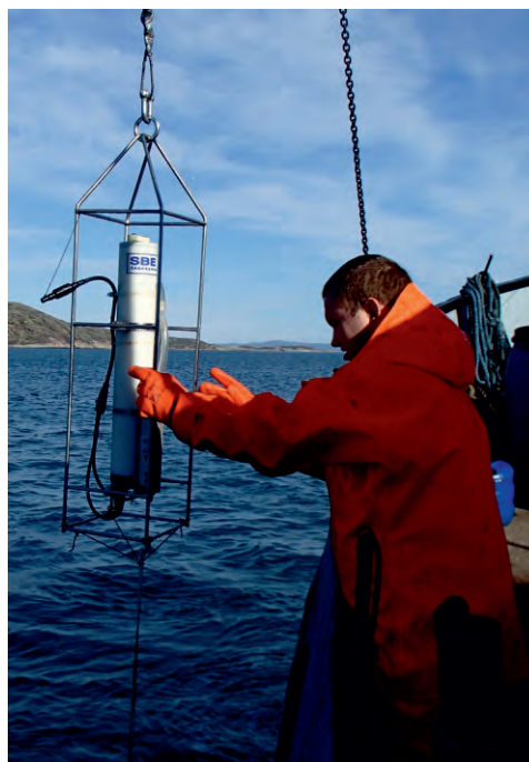
Рис. 4.3. Измерение вертикального профиля температуры и солёности с помощью СТД-зонда Fig. 4.3. Measurement of temperature and salinity vertical profile using a CTD probe
