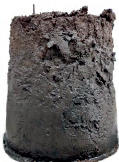
Рис. 6.1. Колонка донных отложений из Кольского залива. Включения гравия в слоях осадков.
