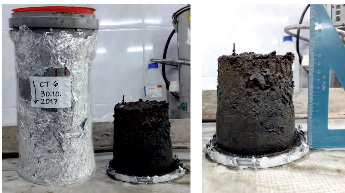
Рис. 6.2. Пластиковый пробоотборник и вырезанный керн донного осадка Fig. 6.2. Plastic sampler and cut core of bottom deposit
