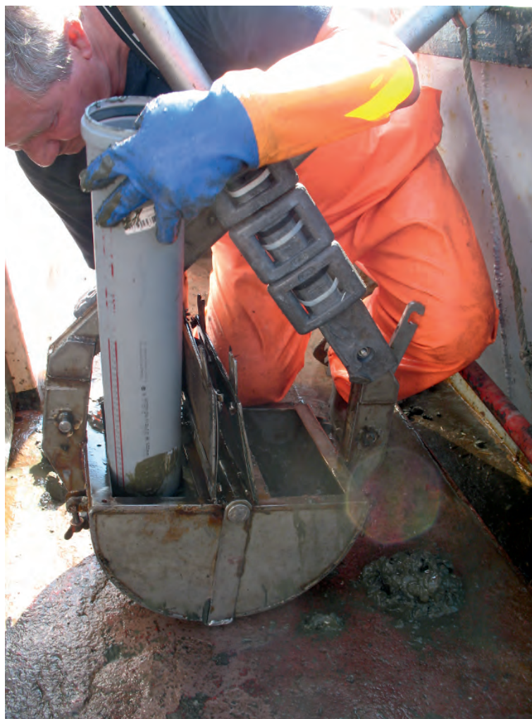
Рис. 4.12. Отбор керн донного осадка из дночерпателя ван Вина с помощью пластиковой трубки Fig. 4.12. Sediment core sampling from van Veen grab with a plastic core tube
