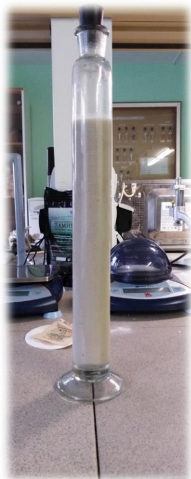
Рис. 2. Образец полученной буровой промывочной жидкости Fig 2. Sample of obtained drilling flushing fluid
